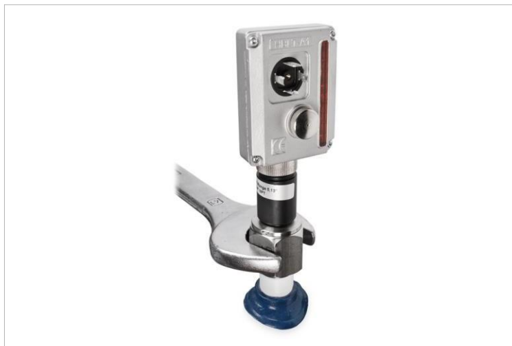
Montați senzorul pe vas. Cuplu 80-150 Nm.
